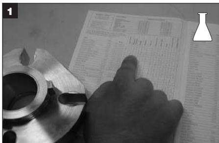
Vérifiez, sur la liste des résistances chimiques, que les joints toriques installés dans cette garniture mécanique sont compatibles avec le ou les fluides concernés.
