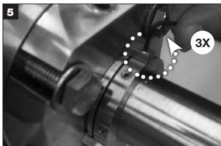
Desserrez les vis d'assemblage à tête creuse et déposez les 3 clips de centrage ; conservez les vis et les clips de centrage pour les réglages ultérieurs de l'impulseur ou le remontage de la garniture mécanique.
